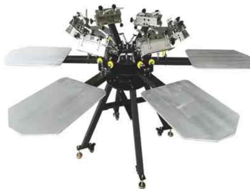
ΜΥΛΟΣ ΜΕΤΑΞΟΤΥΠΙΑΣ 6 ΧΡΩΜΑΤΑ ΜΕ MICRO REGISTRATION Χειροκίνητη μηχανή μεταξοτυπίας με 6 σταθμούς - 6 χρώματα με micro registration & παλέτες αλουμινίου. Μέγιστη διάσταση τελάρου 50 x 70 cm
