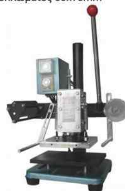
Οικονομική χειροκίνητη χρυσουτυπική μηχανή 160x150mm
