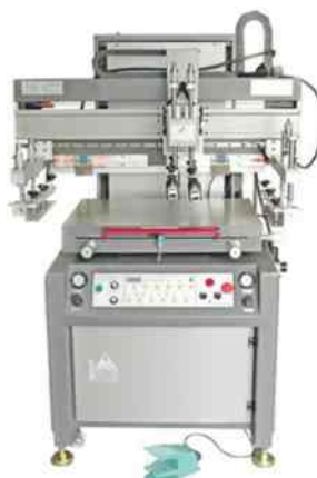
Επίπεδη μηχανή μεταξουτυπίας με βάκουμ 700x1000mm
