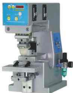
Μονόχρωμη ταμπόν ανοικτού κυκλώματος 85x85mm
