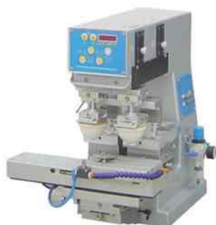
Δίχρωμη ταμπόν ανοικτού κυκλώματος 85x85mm
